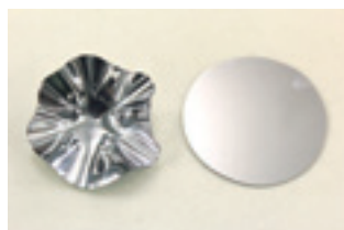
図37 造花用こてで変形させたミラー
