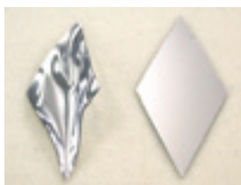
図36 手で変形させたミラー
