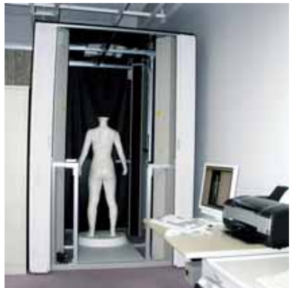
図1 Bodyline Scanner (浜松ホトニクス製)
