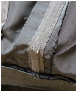
図10 ボーンの破損
